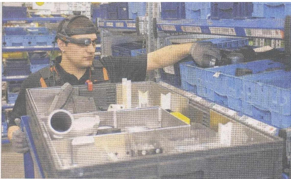
Zielsicher kommissionieren: Im Motorenwerk Mannheim von Daimler stellt ein Mitarbeiter Bauteile und Komponenten für die Montage mithilfe eines „Head-Mounted Display“ zusammen. Foto: Matthias Ernst
